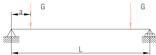
Рисунок 7: схема нагружения поперечины нагрузкой от собственного веса заполнения
